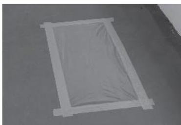
Repita este procedimento em todos os ambientes em que o Durafloor será instalado. Se após esse período o plástico apresentar pequenas gotas d'água de condensação ou escurecimento da superfície, o contrapiso tem umidade e, portanto, deve ser impermeabilizado por um profissional especializado que ofereça garantia do serviço.
