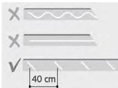
Fixe o rodapé na parede exercendo pressão, de forma que o adesivo tenha contato com ambas as superfícies. Se precisar, dê leves batidas com o martelo de borracha para ajustar.
