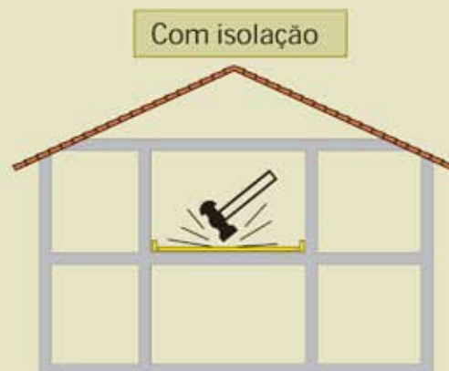
Fig.2 – ruído gerado pelo martelo diretamente no piso, sendo absorvido em quase sua totalidade pela lâ de vidro aplicada no piso. Atentar para detalhe de aplicação que inclui os rodapés do ambiente, evitando assim, pontes de transmissão sonora pela estrutura.
