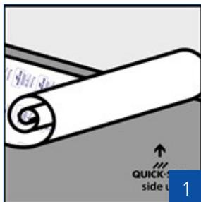
1. Desenrole o underlay no subpavimento com o logotipo virado para cima. O subpavimento deve estar limpo, seco e plano. Coloque as tiras do underlay paralelamente à direção de colocação do seu pavimento.
